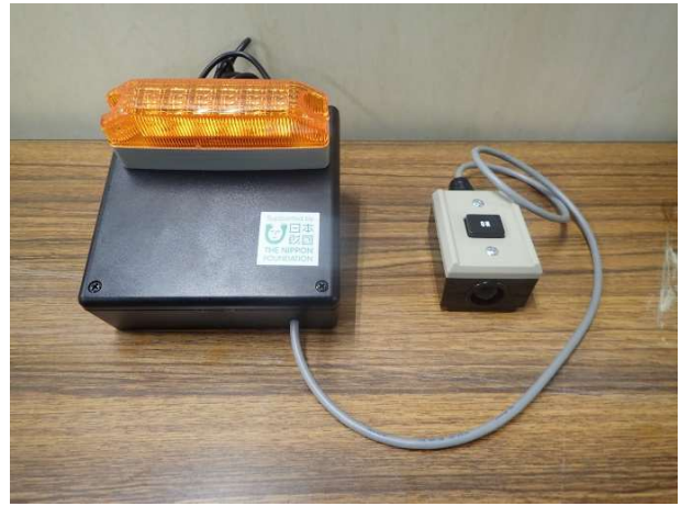
排煙窓スイッチと演出ランプ
