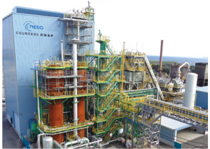
「COURSE50 試験高炉」水素還元比率を拡大する実証実験でCO 2 の10%削減目標を達成した 提供：日本鉄鋼連盟
