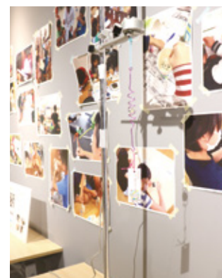
「サッカクビー玉エレベータ」 錯視を利用した工作。アルミワイヤーをモーターで自動回転させるとビー玉が永遠に上り下りしているように見えます
