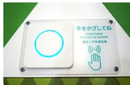
ウィズ・コロナ時代に再開館する科学館のために、触らずにスイッチを入れられる機構も随所に用意
