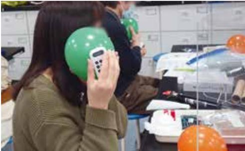
「音のレンズ」の実験。二酸化炭素を入れた風船にタイマーを密着させ音を鳴らし、波が重なり音が大きくなる現象を調べた
