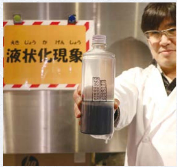
液状化現象を実験するボトル。噴砂現象や地盤沈下の様子も観察できる
