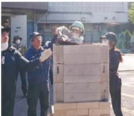
原料の砂鉄をスコップで入れる参加者。炉を構成する耐火レンガは今年も黒崎播磨株式会社より提供いただいた
