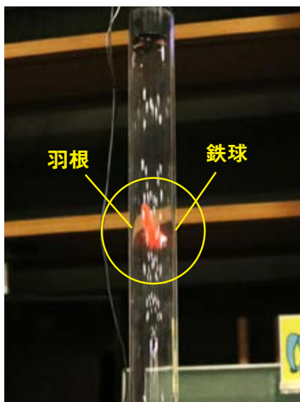
電磁石のスイッチを切ると、鉄球と羽根がほぼ同時に同じ速度で落ちた！
