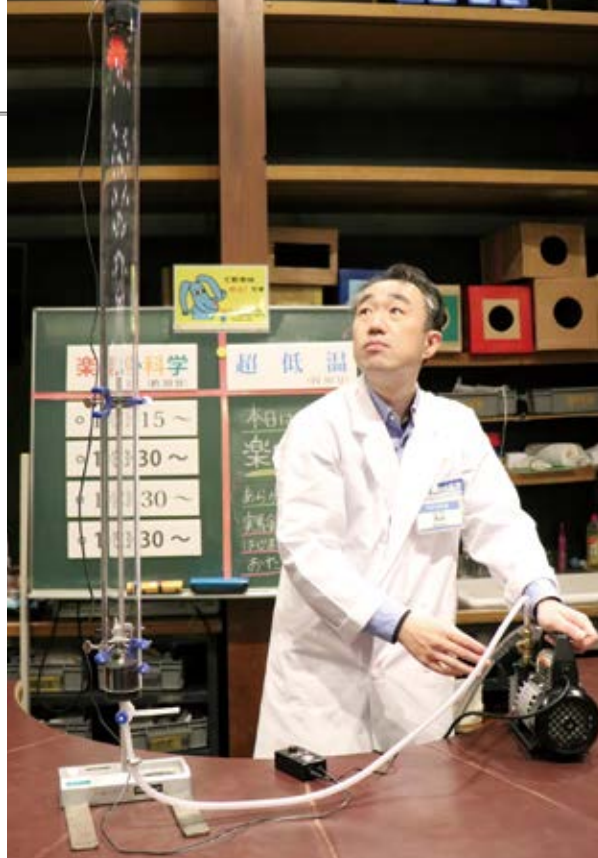
約 1 m の高さになる「真空落下実験装置」。右の真空ポンプで左の管の空気を抜いていきます
