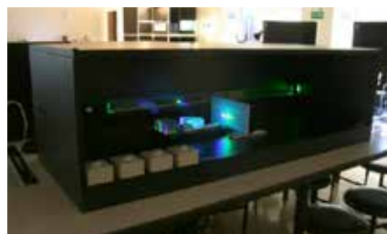
〈レーザー光線の進み方〉レーザー光線がアクリル材の中を真っすぐ進む直進性の様子と、青・緑・赤色のレーザー光線を凸レンズに通すと、1か所に光が集まる点（焦点）があることを確認できる
