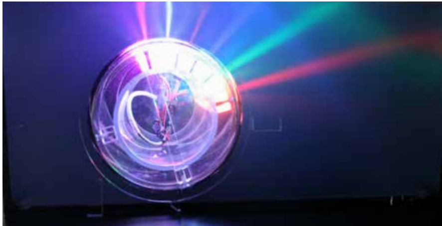
〈水の中を光はどう進む？〉水槽の中にある光源から出た光が水の中を通り空気中に出る時に、境界面で屈折したり、水面下で全反射してくの字に折れ曲がる現象を体験できる
