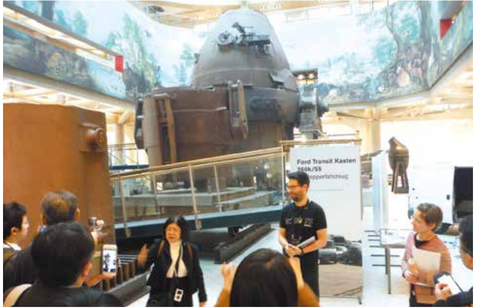
【世界初のLD 転炉法の炉】 LDは開発された地名、リンツとドナヴィッツを表す
