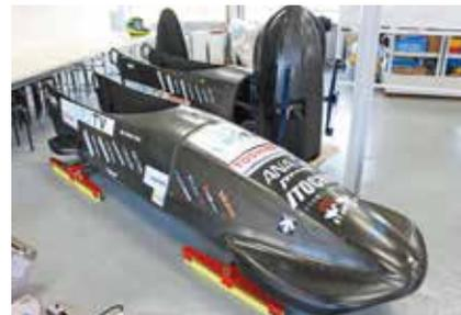
自社工場に置かれた2号機。ボディはCFRP（炭素繊維強化樹脂）製。国産F1カー・童夢を設計した東レ・カーボンマジック（株）の奥明栄氏が担当した
