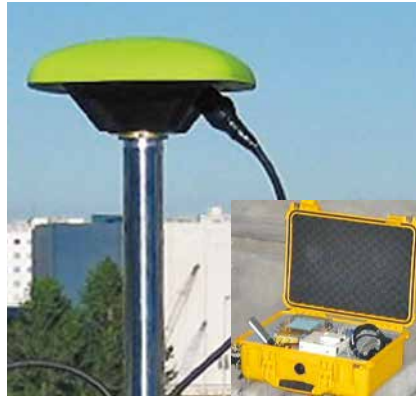
見晴らしのよい科学技術館屋上に設置されるものと同型のGNSSアンテナと受信機。GNSS衛星から届く電波の到達時間の遅れを利用して水蒸気分布を観測する
