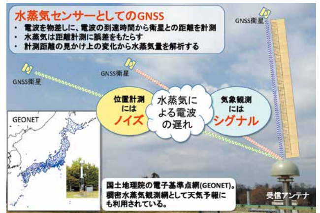
図3 水蒸気による電波の遅れを利用するGNSS気象学
