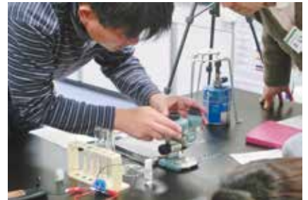
【イオン化傾向実験で顕微鏡をのぞく（化学）】 マグネシウム片を硫酸亜鉛水溶液に、亜鉛片を硫酸マグネシウム水溶液に入れ、変化を比較観察
