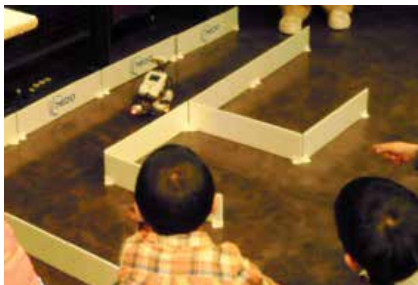
【新規プログラム「ロボットの技術」の実演】 光センサを使って壁をよけながら迷路を進むロボットの实演
