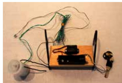
【科学技術館館長賞作品】 自転車のスタンドに取り付けたフィルムケースがセンサーの役割を果たし、通電すると板に留めめるブザーが鳴る
