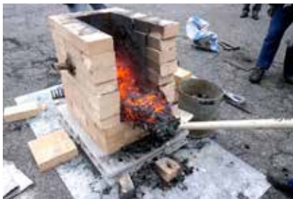
【炉からケラを出すところ】 炉の側面を1面だけはずし、スコップでケラを取り出す。ケラはまだ赤々としている
