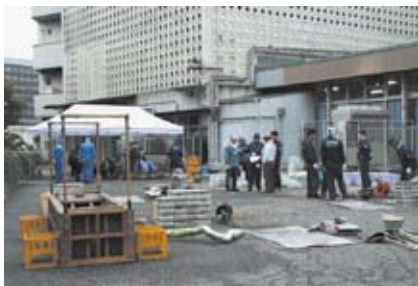
【実験の準備を進めるNPO たたらスタッフ】 館内で説明を受けている間、広場では着々と準備が進む。左端の木箱が「踏み鞆（ふいご）」
