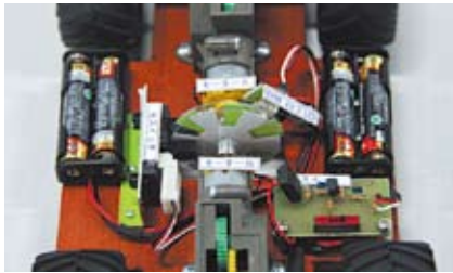
【館長賞作品展示の車のクローズアップ】 光スイッチで感受する光量の差異によってモーターの回転速度を制御するという画期的なアイデア
