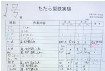
【たたら製鉄実験の記録用紙】 「火入れ」の時間、「砂鉄」や「木炭」を入れた時間や量を細かく記入する表
