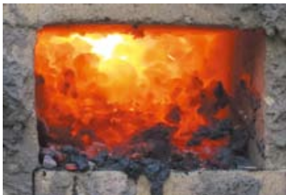
【たたら炉の中の様子】 高温の炉の中では砂鉄と木炭が複雑に作用しあい、砂鉄から銅がでる
