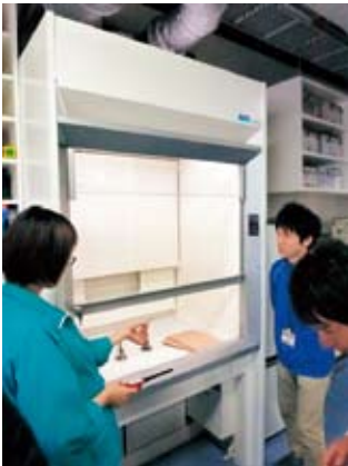
【新しく導入した実験装置1】 有毒物質を扱う時など、安全のために用いる局所排気装置「ドラフトチャンバー」
