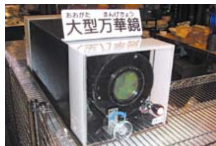
【大型万華鏡 改修後】 ボタンを押すと自動で筒が回転し、ハンドルを回すとクランク機構によってLEDが上下に動き、さまざまな模様が見える
