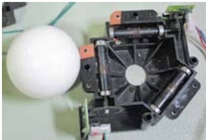
【鳥取市歴史博物館での展示装置点検】 展示装置点検により、トラックボール内のサビを確認し、クリーニングを実施
