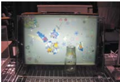
【内照式偏光板展示装置 改修前】 光の色を偏光させる手前の偏光板は1枚だけだった
