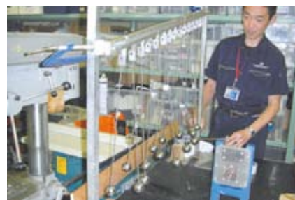
【WAVE 振り子試作実験】 振り子の周期を安定させ、きれいな波になるように調整している様子
