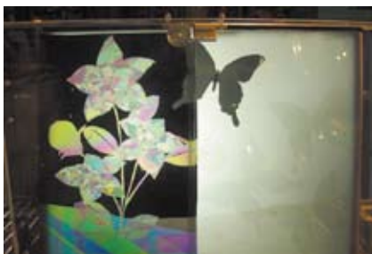
【内照式偏光板アート展示装置 改修後】 観音開き状の偏光板扉を開閉することで、偏光板がある場合とない場合を比べられるようにした
