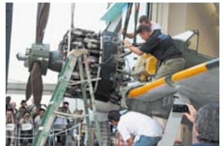
【零戦解体（分解）見学会の様子3】 零戦本体から、フォークリフトを使って栄エンジンがゆっくりと外される
