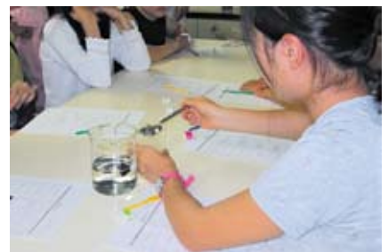
【「石炭を取りだそう」より選炭体験】 見た目はそっくりの石炭と石だが、比重液に入ると浮くもの(石炭)と沈むもの(石)とに分かれる
