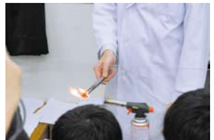
【石炭の燃焼実験】 石は大きな炎でも燃えず、石炭も点火用ライターの炎では火が付かないが、ガスバーナーではこの通り
