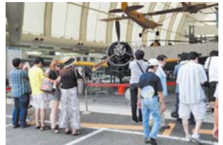
【零戦解体（分解）見学会の様子2】 カウリングカバーが外され、栄エンジンがむき出しの零戦
