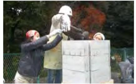
【2月5日「たたら製鉄実験」砂鉄と木炭の投入】
