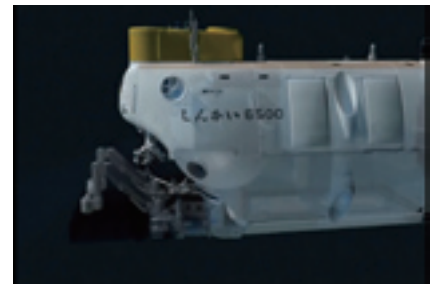
【動画中のしんかい 6500】 日本の深海調査はこの有人調査船「しんかい 6500」、無人探査機「かいこう 7000 II」などによって進められている
