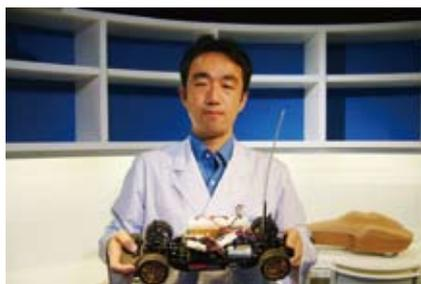
いくつかの装置を開発しましたが、特に苦勞したのは、電気自動車の特徴を説明するための電動ラジコンカーでした。1/10スケールの既製品模型を使いましたが、そのままでは簡単に20km/h程度の速度が出てしまい危険です。しかし保守性や信頼性を考えると、可能な限り既製品を使う必要があります。そこで、速度を1/10程度に抑える改造を加えました。
