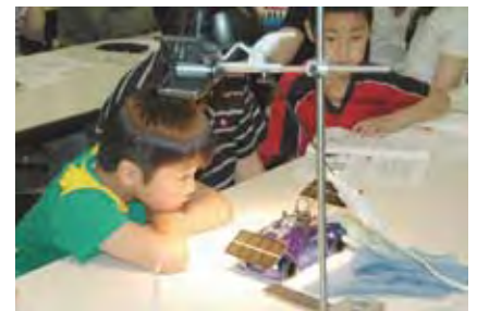
【燃料電池】 太陽電池で水を電気分解してつくった水素を使って燃料電池を積んだ模型自動車が走行。燃料電池のしくみと効果について学んだ
