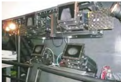
【分光方式による立体視】 Infitec フィルタ内蔵のプロジェクトで、左眼用と右眼用で異なる波長の映像を投影
