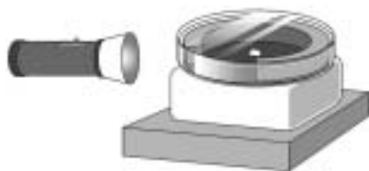
ドライアイスの上にシャーレを置き、その中に石を入れて蓋をし、真横から光を当てて観察する
