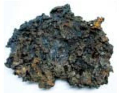
砂鉄を原料とする日本古来の製鉄法「たたら製鉄」によってできた「けら」。純度の高い鉄を含んでいます。
