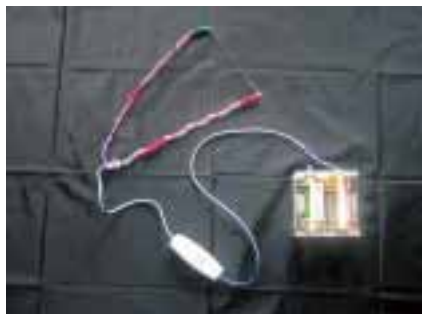
【工作教室「発泡スチロールカッターの製作」】 電熱線（ニクロム線）に乾電池で電流を流し、生じる熱で発泡スチロールをカットする
