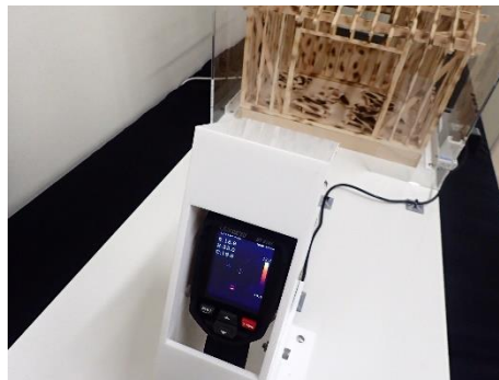
サーモカメラで熱源を確認しよう
