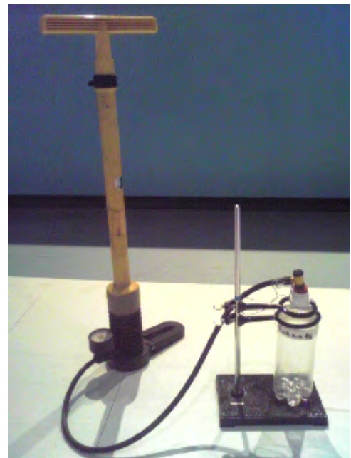
写真2 【製作物】シャルルの瓶 MINI 自転車の空気入れを使って、 500ml サイズのペットボトルに空気を詰め込む。
