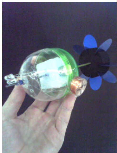
写真9 【製作物】火力発電モデル 羽根の部分をアルミ製にすることで、 蒸気に耐えられるように改良した。
