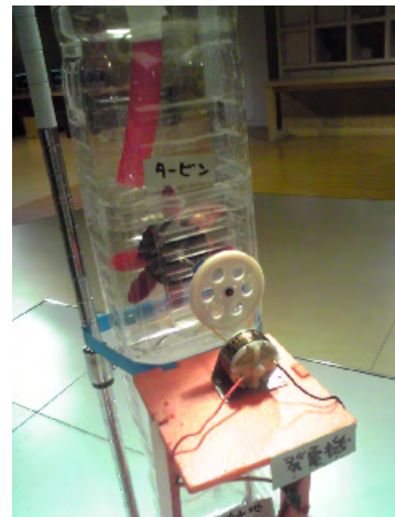
写真 10 水力発電モデル・タービン部 大型プーリーとベアリングを採用。
