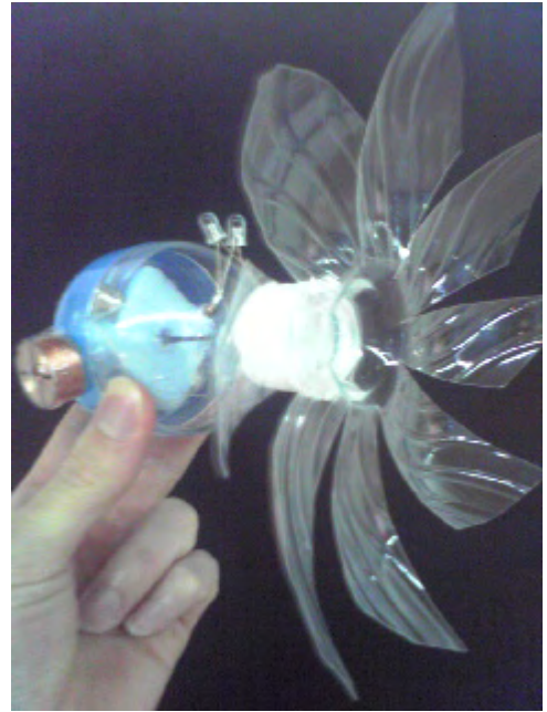
写真8 【製作物】風力発電モデル ガチャガチャのケースで作られた発電機を、 ペットボトルの羽根で回転させる。
