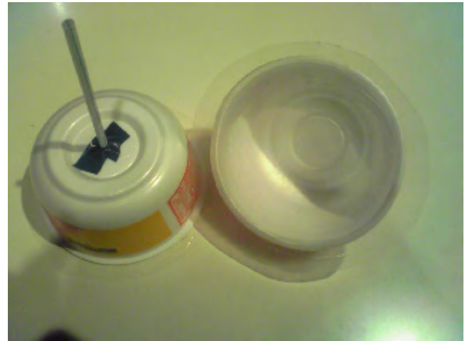
写真6 【製作物】マグデブルグのカップラーメン 2つの容器を合わせ、ストローを使って中の空気を抜く。 大気圧を感じることができる。
