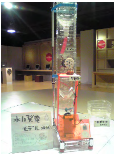
写真7 【製作物】水力発電モデル ペットボトルで製作されたモデルで、 水力発電の仕組みをイメージさせる。
