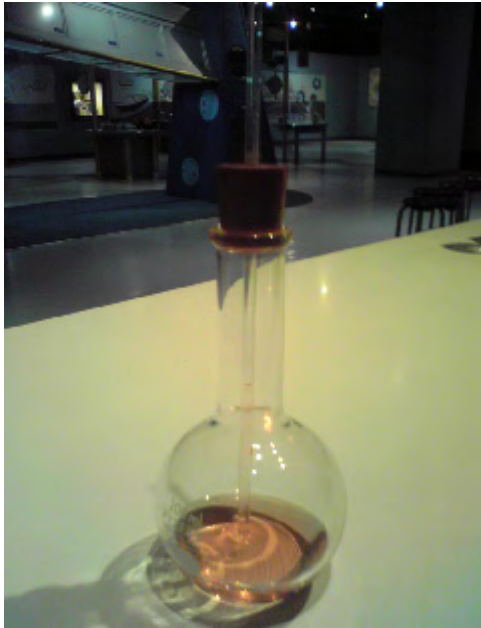
写真4 【製作物】マリオットの温度計 MINI 小さめのフラスコと、食紅で色を付けた水を使用。 フラスコはペットボトルで代用が可能である。
