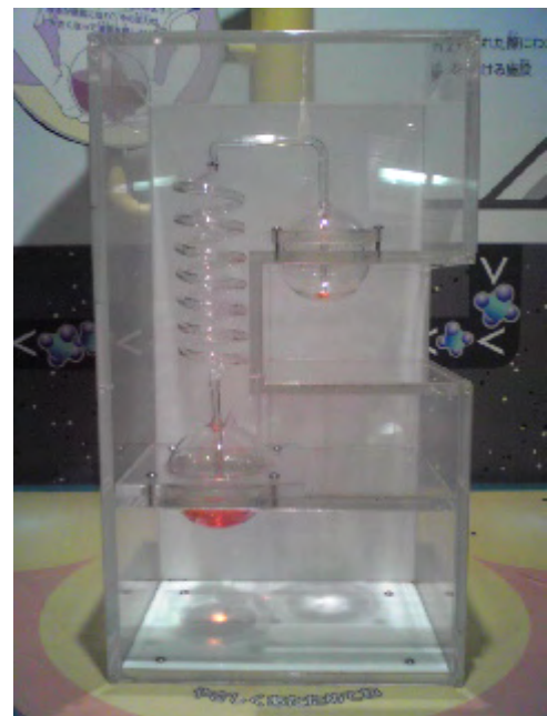
写真3 【展示物】マリオットの温度計 液体の入った丸い部分に手を当て、 温めることで液体が移動する。
