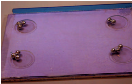
写真8 軽量住宅用 ボールベアリング免震模型
